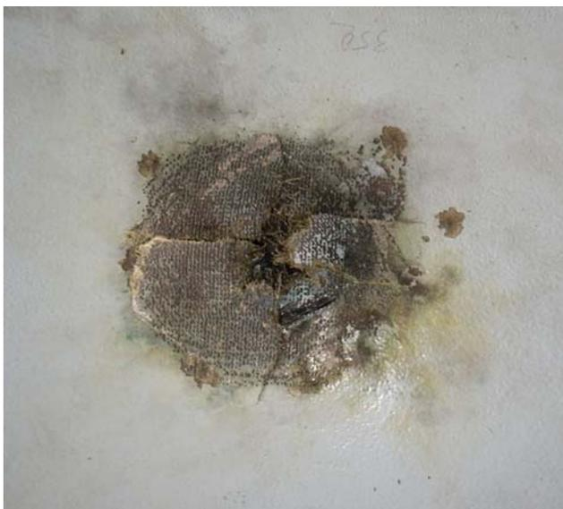
Рис. 16. Общий вид зоны повреждения  $\varnothing$  100 мм при воздействии импульсной компоненты  $A$  тока молнии на опытном образце толщиной 3 мм композиционной обшивки ЛА
